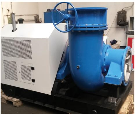
Pumpa je centrifugalna s horizontalnom usisnom granom. Potisna grana pumpe je vertikalno postavljena s mogućnošću okretanja za 360°.
